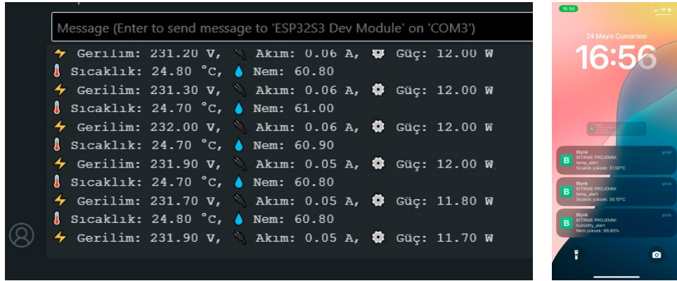
Şekil 2. Arduino IDE’den Verilerin Okunduğu Görsel ve Eşik Değerler Aşıldığında Gelen Bildirim Görseli
