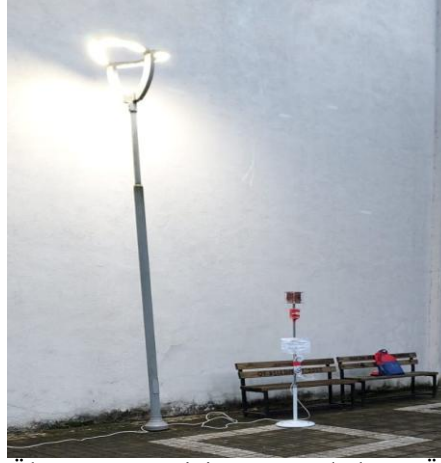
Şekil 2. GNSS Ölçüm Düzenine LED Aydınlatma Önünde Yerleşimi
