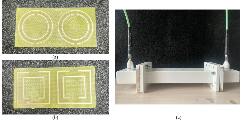
Şekil 4. Tasarımlara ait prototipler (a)Top-1 , (b) Top-2 ve (c) Ölçüm düzeneği
