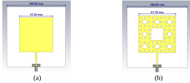
Şekil 1. Sierpinski Halısı Fraktal Geometrilili Antenin (a) Temel Biçim Tasarımı (b) Üçüncü İterasyon Tasarımı.
