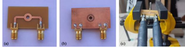
Şekil 2. Üretilen sensörün (a) ön, (b) arka yüzlerinin ve (c) ölçüm düzeneğinin fotoğrafları
