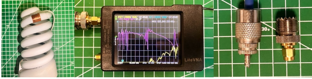
Şekil 2. Sleeve kuplaj yönteminin – Nano Vector Network Analyzer – SMA konektör
