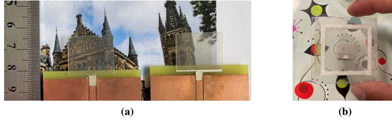
Şekil 4. Gümüş nanotel şeffaf anten prototipleri: (a) düzlemsel tekkutup anten, (b) yama anten.
