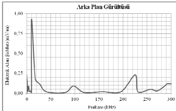
Şekil 4. 50 Hz - 300 kHz frekans aralığında ortamın arka plan elektrik alan şiddeti
