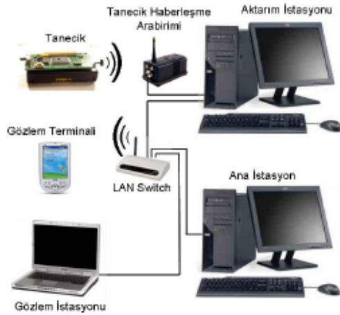
Şekil 3. Kablosuz Algılayıcı ve Bilgi Sistemleri Ağı.
