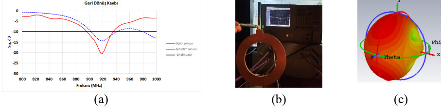
Şekil 3. Antenin geri dönüş kaybına ait (a) benzetim ve ölçüm sonuçlarının karşılaştırması ile (b) ölçüm fotoğrafı ve (c) antenin yönlü ışınma patemi
