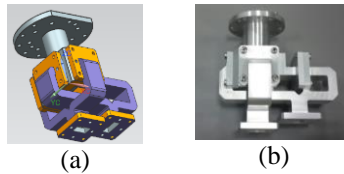
Şekil 4. (a) Turnstile OMT Katı Modeli, (b) Üretilen Turnstile OMT
