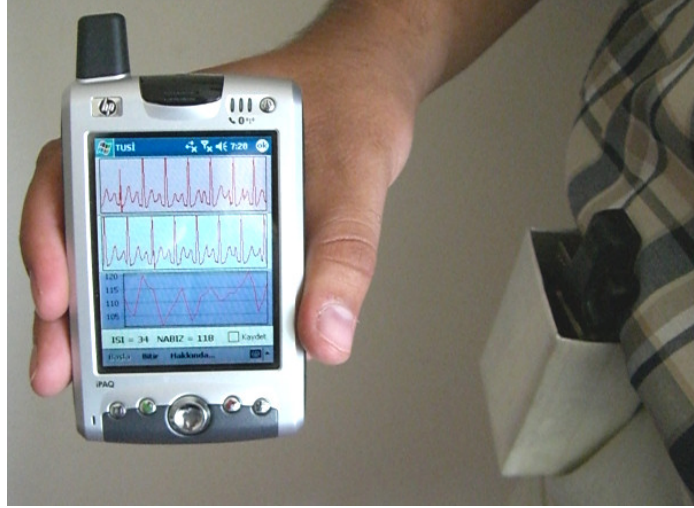
(b) PDA ve kişi üzerindeki Taşınabilir İzleme Birimi.
