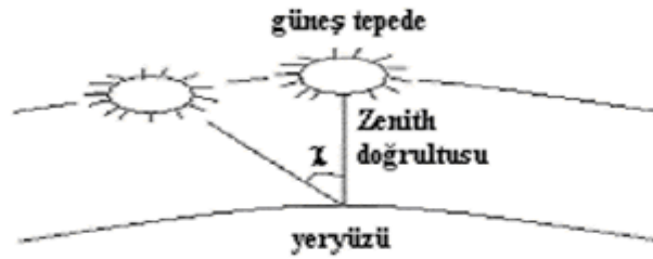
Şekil 1. Zenith açısının güneşin konumuna göre değişimi
